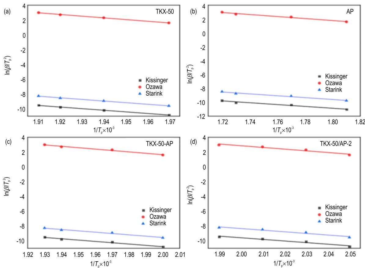
图 5 (a)TKX-50、(b)AP、(c)TKX-50-AP 及(d)TKX-50/AP-2 样品的不同方法拟合图
