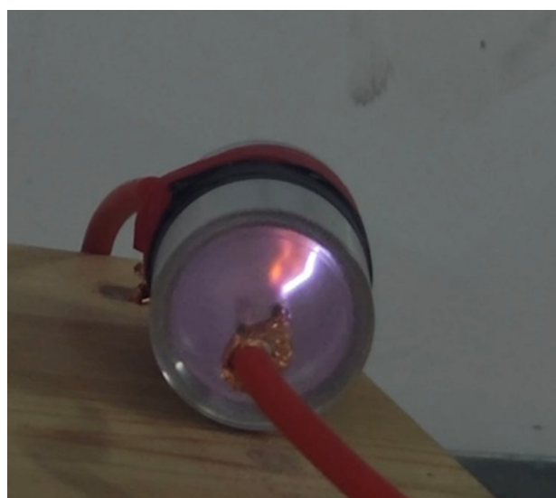
图 10 电击穿过程电弧现象
