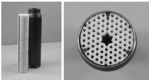
图5 装填前(左)和装填后(右)带有3D打印推进药柱的弹筒 [17]
