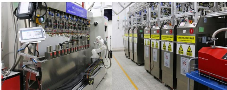
图6 自动化布氏压力计测试系统
