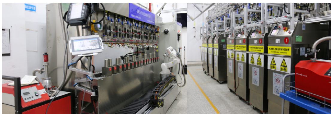
图6 自动化布氏压力计测试系统
