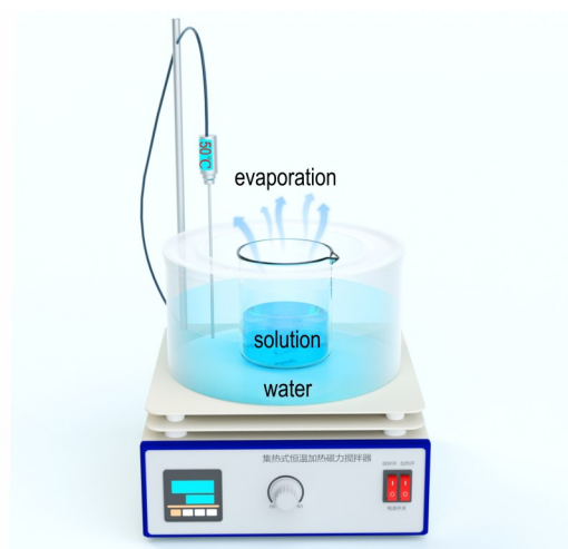
图 4 AP/KP 溶剂蒸发样品试验装置图
