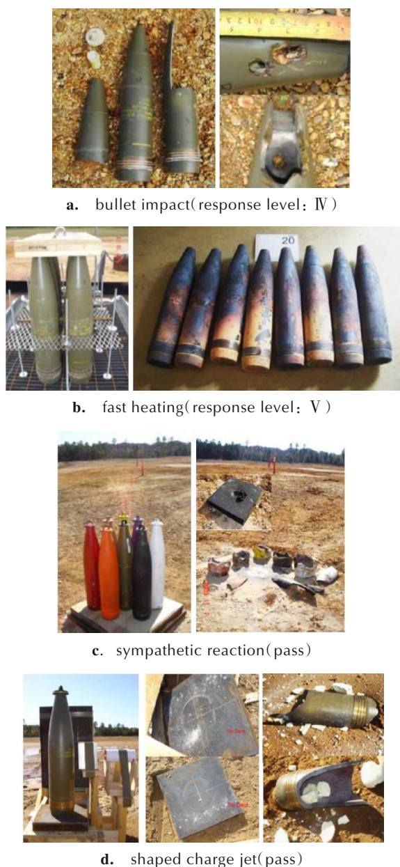
图1 装填IMX-101的M795弹药IM试验典型结果 [50]
