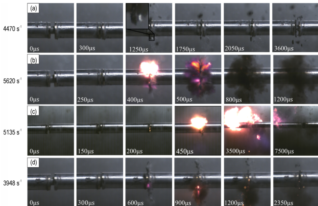
图8 Al/HTa/PTFE材料撞击点火过程(a. II#; b. III#; c. IV#; d. V#)
