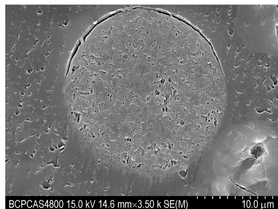
图11 nAl@PVDF@CL-20复合微颗粒的球剖面SEM图
