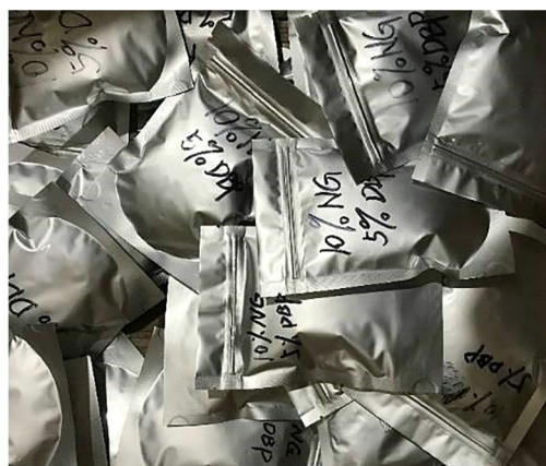
图5 装入铝箔/PE复合密封袋的发射药老化实验样品
