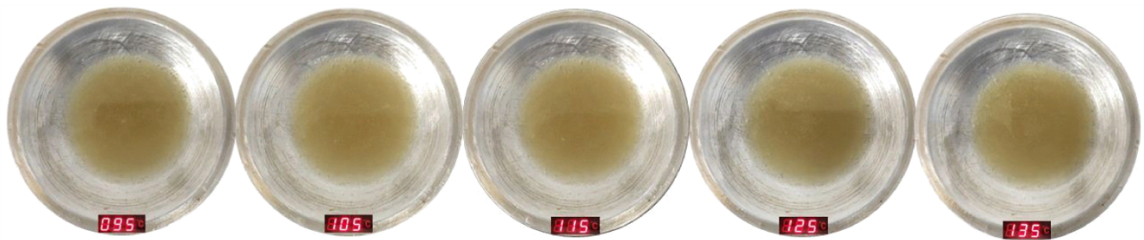
图2 BOM 不同温度下的熔融液
