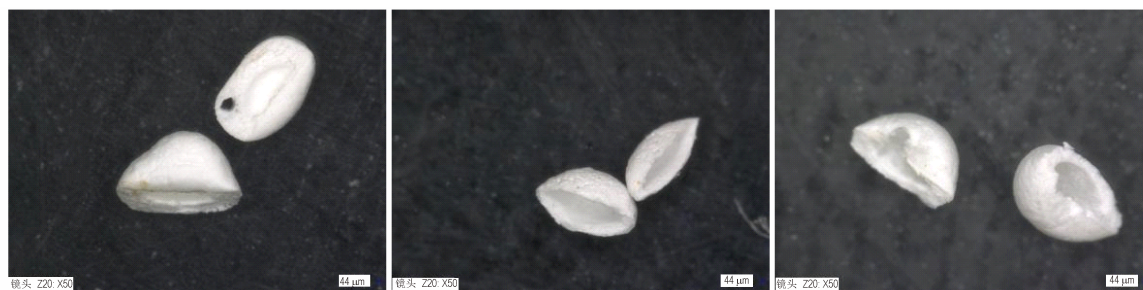
图5 含能空芯球形壳体剖面图
