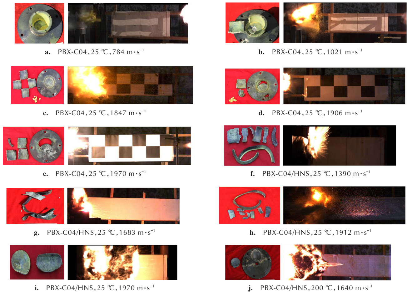
图6 撞击试验后试验件残骸情况及高速摄影影像
