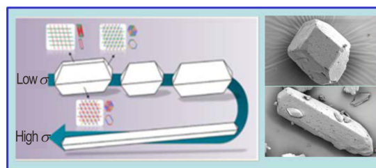
图5 过饱和度对 \beta -HMX形貌的影响 [37]
