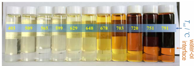
图6 不同反应温度下 EtOH/EHF@NiZSM-5+Hm(0.1%) 实验的液相产物照片
