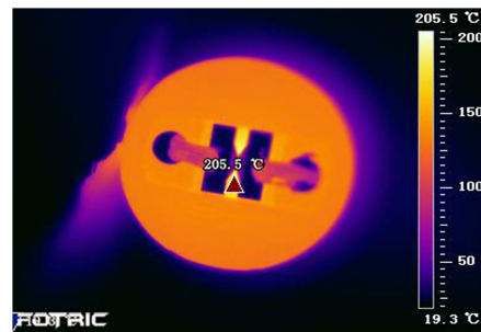
a. Ni-Cr thin film igniter
