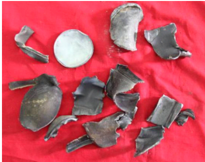
图4 TKX-PBX快速烤燃试验后装置壳体碎片
