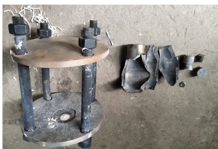
图4 实验后热应力测量装置的残骸
