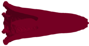
图8 EFP成型图(200 μs)
