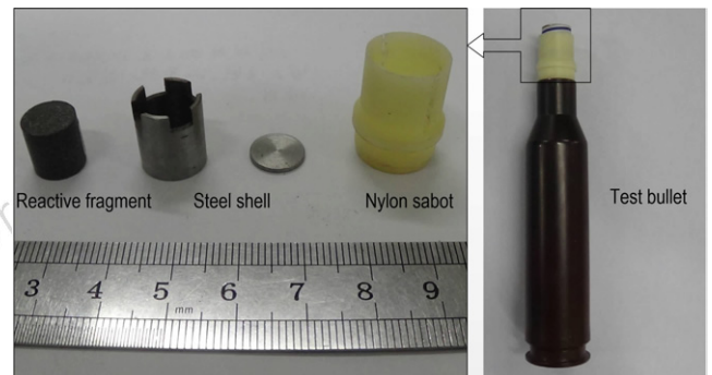
图 3 反应破片、弹托及测试弹
