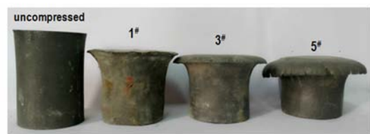
图4 铅柱压缩前后对比图
