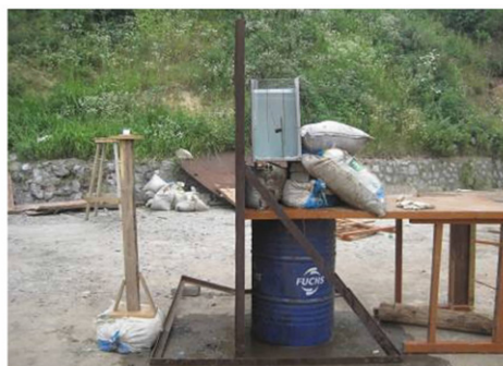
图 8 EFP 水中侵彻试验布置图
