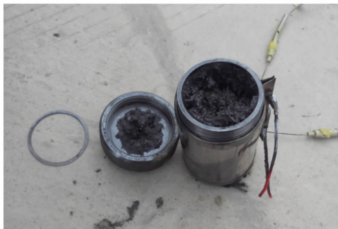
图3 DNAN炸药点火后烤燃弹照片
