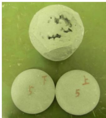
图 1 MX-2 炸药药柱样品及其剖面外观
