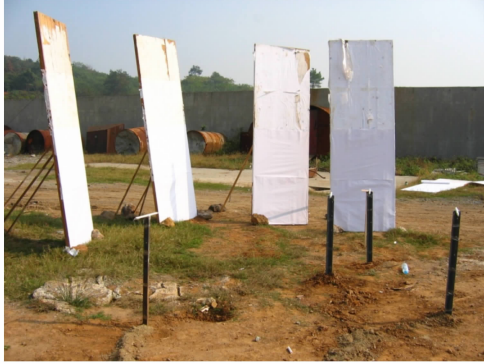
图 7 低附带模拟弹静爆试验现场布置图
