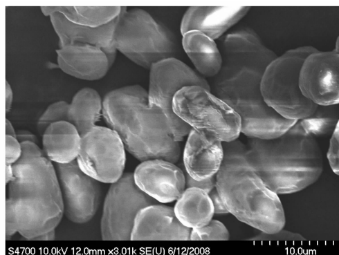
图 1 超细 RDX 扫描电镜照片
