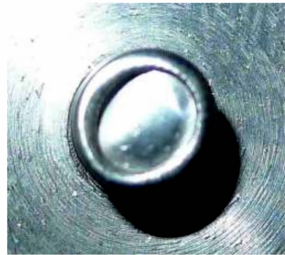
图 6 横向加载后雷管输出端面变形图
