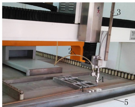
图3 射流切割平台 1—喷嘴, 2—磨料管道, 3—高压水管道, 4—样品, 5—切割平台
