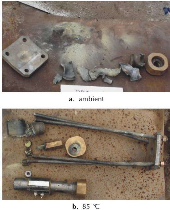
图 4 PBX-2 炸药 DDT 试验结果照片
