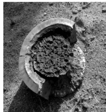
图 7 隔板试验后见证板破坏情况
