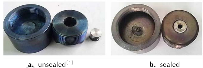
图 6 3 号药柱在密封和非密封状态下的试验结果对比 Fig. 6 Results of with 3# cylinder sealed and unsealed
