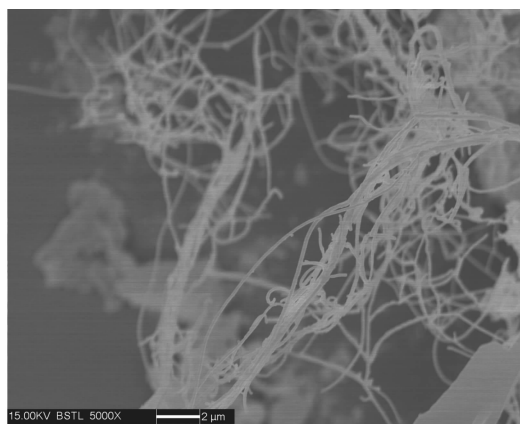
图 1 二氧化硅纳米管的 SEM 图
