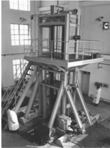
图 2 大落锤加载装置
