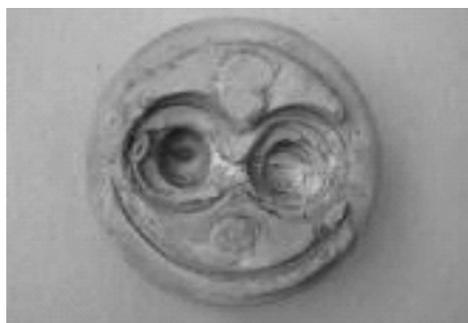
图 6 端盖高速撞击后形变现象
