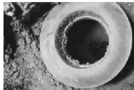
图 5 装填 PBX-2 弹体侵彻试验后照片
