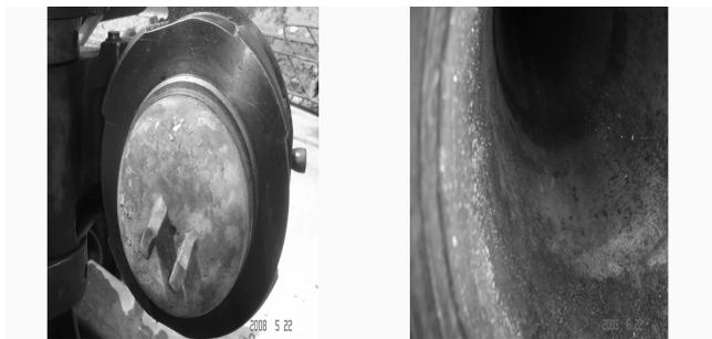
图1 某火炮刚性装药射击1发后的炮闩(左)和药室(右)状态
