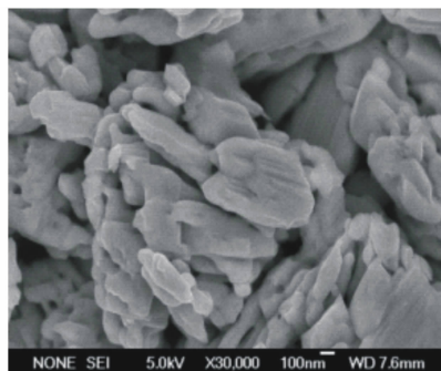
图 2 纳米 MoO 3 冷场扫描电镜图片 (3 × 10 4 ) Fig. 2 SEM image of nano-MoO 3 (3 × 10 4 times)
