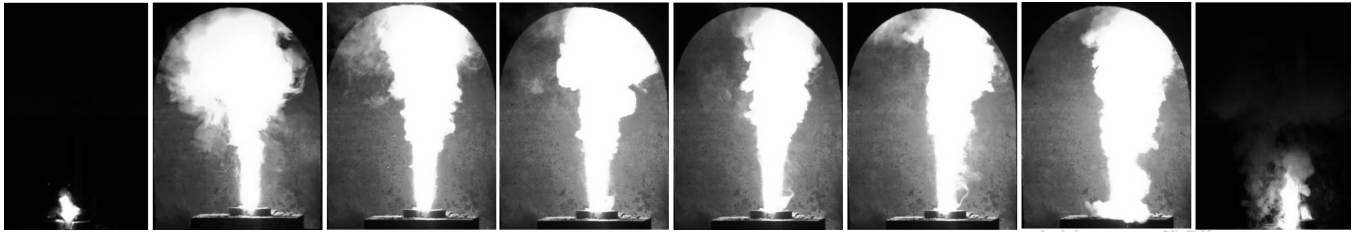
图2 3#推进剂点火、燃烧、结束过程(图片时间间隔0.5 s)
