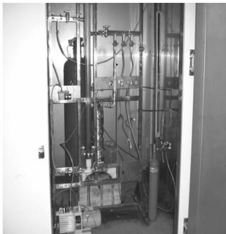
图 1 可燃液体爆炸极限测试装置
