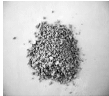
图5 物料经旋风切割机粉碎后直径约为1mm,底部与AP颗粒分层
