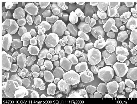
图7 冷冻干燥条件下制得RDX/ \text{SiO}_2 膜的扫描电镜图
