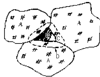
图1 高聚物粘结炸药微观结构 Fig. 1 Meso-structure of PBX-9404
