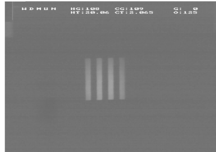
图 2 未释放烟幕前红外热像仪的靶标
