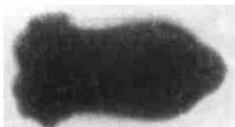
图 7 单点中心起爆形成的 EFP
