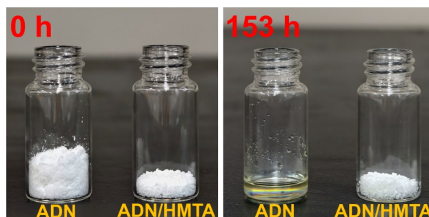
图8 25^\circ\text{C} 、 70\% 相对湿度下吸湿前后的ADN与ADN/HMTA共晶
