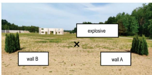
图4 金钟柏爆炸试验布置<sup>[63]</sup>
