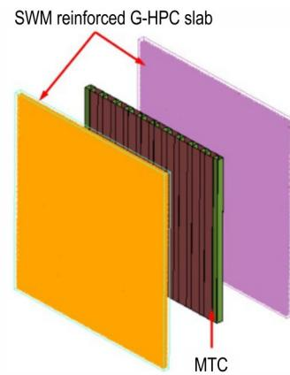
图 15 新型夹层抗爆墙<sup>[128]</sup>
