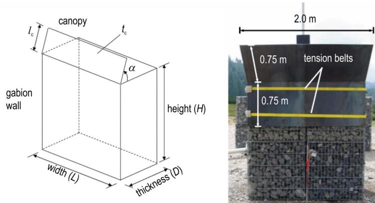
图 11 加盖顶棚式抗爆墙<sup>[102-103]</sup>Fig.11 Covered ceiling blast wall<sup>[102-103]</sup>
