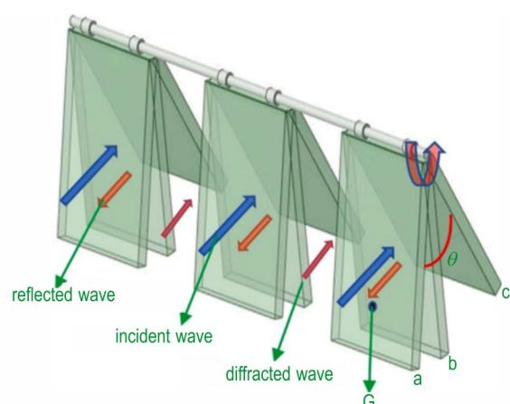
图 14 幕墙式抗爆墙<sup>[110]</sup>Fig.14 Curtain-type blast wall<sup>[110]</sup>
