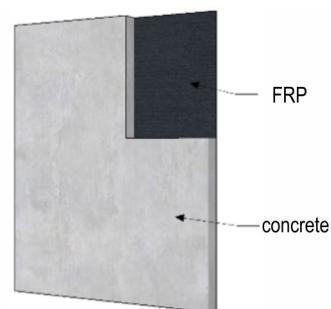
图3 FRP加固混凝土抗爆墙
