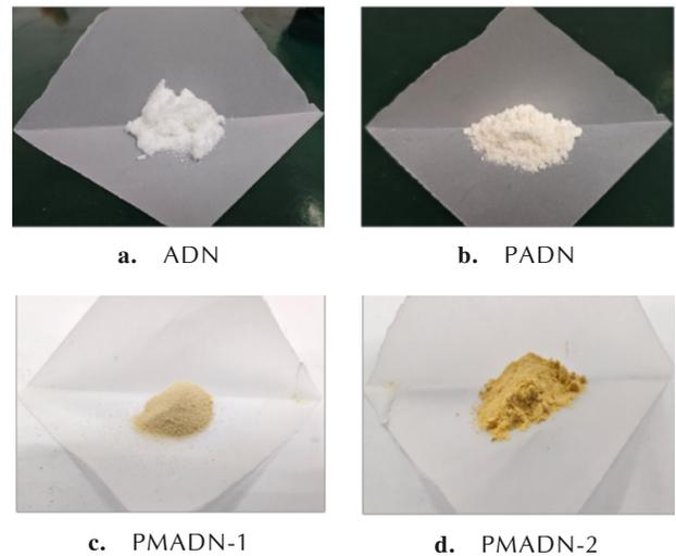
图 2 改性及球形化前后 ADN 的实物图片
