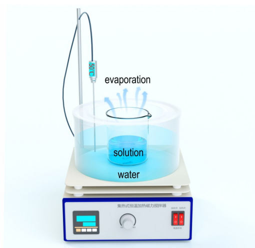
图4 AP/KP溶剂蒸发样品试验装置图
