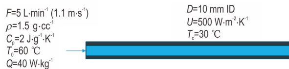
图1 通道式反应器实际传热的仿真计算模型
