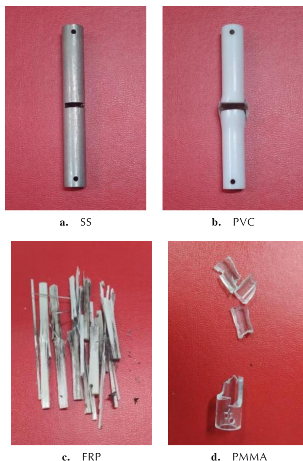
图7 爆后不同切缝管形态变化
