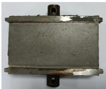
图3 标准HTPB推进剂矩形试件
