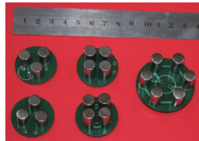
图 17 基于冲击片雷管的多点同步起爆系统 [54]
